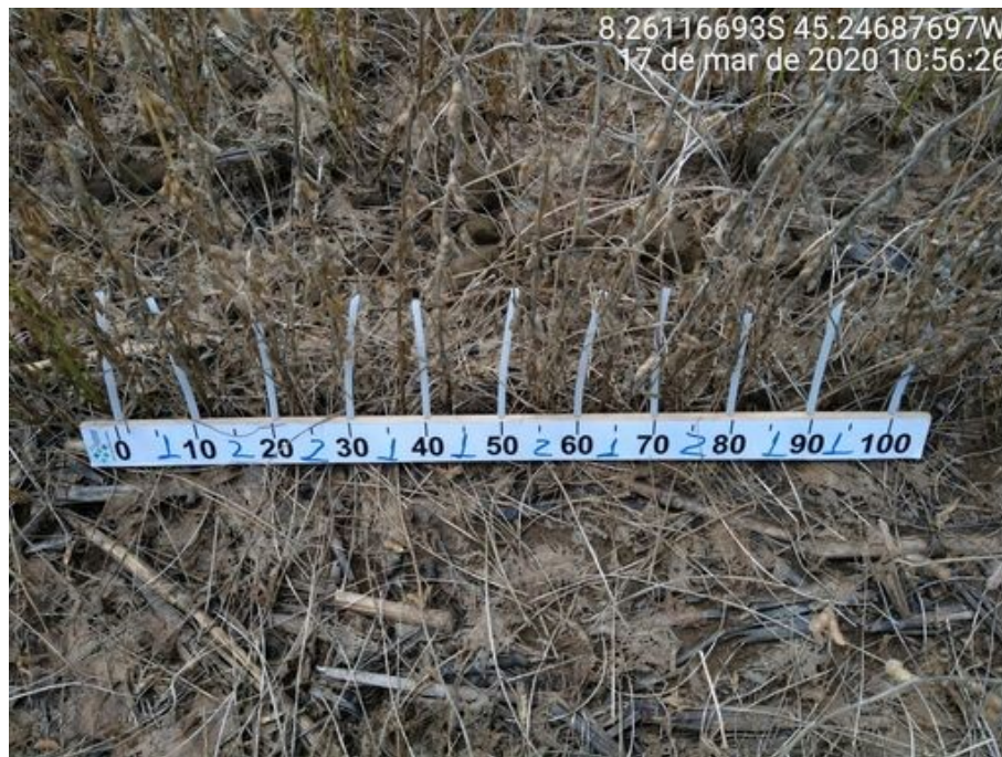
7 | Aferição da Taxa de semeadura efetiva (gabarito graduado 1/10cm)
